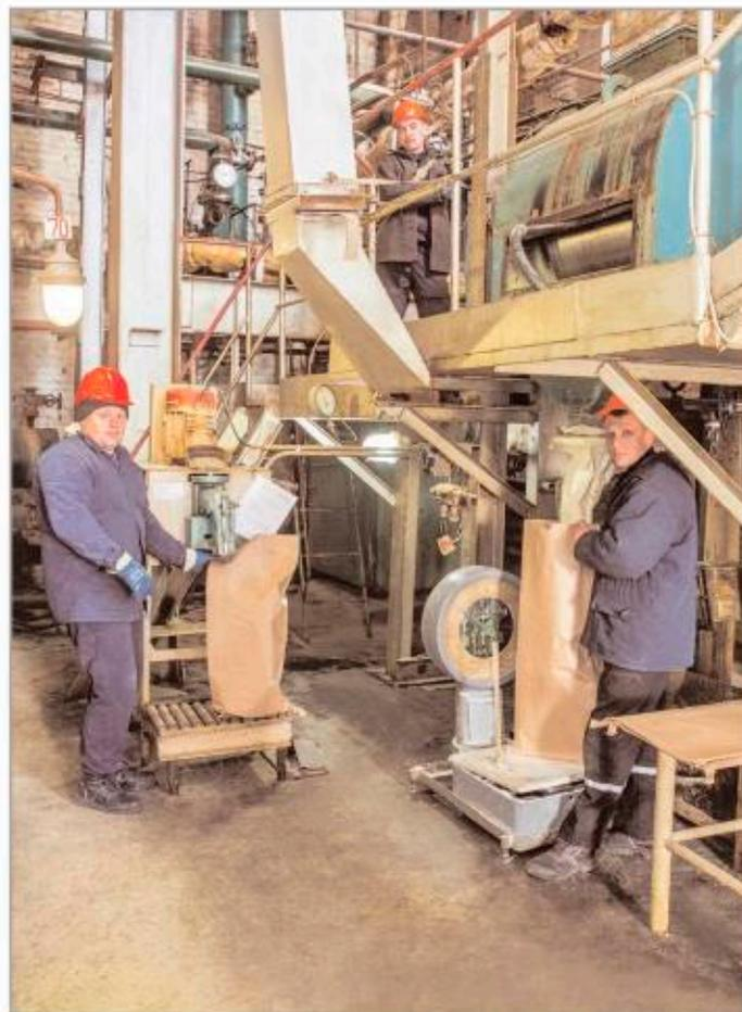
Для выпуска Октофора-Nш в цехе Н-4-5 использовали имеющееся оборудование, адаптировав его к технологии производства нового продукта. На снимке: ст. аппаратчик алкилирования Д.Гафеев производит регулировку подачи на барабан чешуирующей расплава Октофор-Nш, машинист технологических насосов Д.Калугин осуществляет выгрузку готовой продукции в мешки, аппаратчик смешивания С.Фролов производит окончательный штрих(прошивку мешков) перед отправкой.
